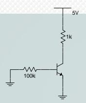
Resposta:  $I_B = 0$ ;  $I_C = 0$ ;  $I_E = 0$ ;  $V_{CE} = 5V$ .
