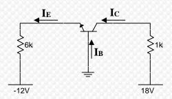
Resposta:  $\alpha$  = 0,988;  $I_E$  = 1,9mA;  $I_B$  = 23,75 $\mu$ A;  $I_C$  = 1,87mA;  $V_{CE}$  = 15,53V;  $V_{CB}$  = 16,13V. 2. Determinar R<sub>C</sub>, R<sub>E</sub>, sabendo-se que  $I_C$  = 1,5mA,  $V_{CE}$  = 6V,  $\alpha$  = 0,98,  $V_{EE}$  = -18V e  $V_{CC}$  = 12V
