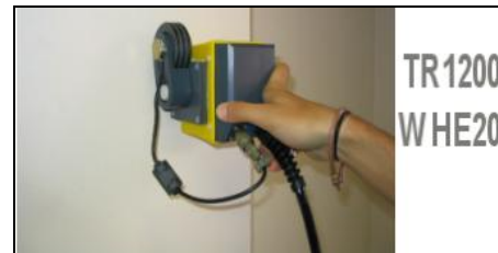
Figura 3 – Foto do equipamento GPR com antena de 1200 Mhz.
