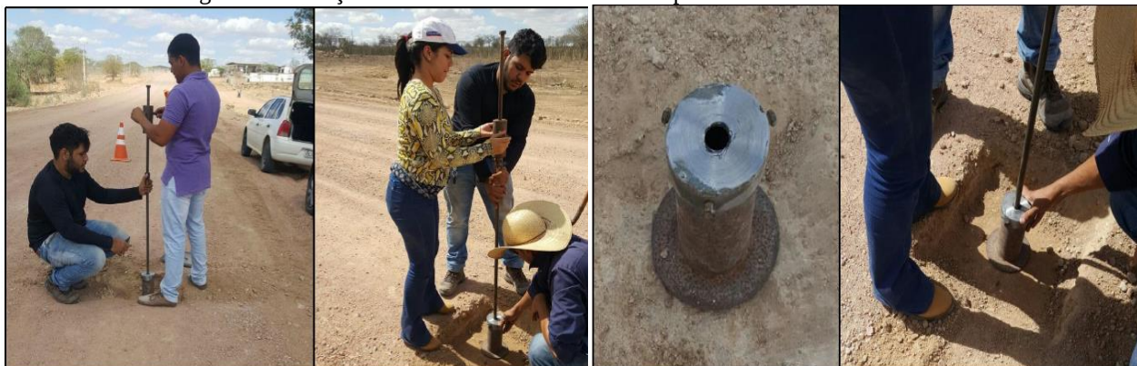
Figura 1: Execução de Ensaio Barra Mina em Campo e Detalhe da Base Niveladora
