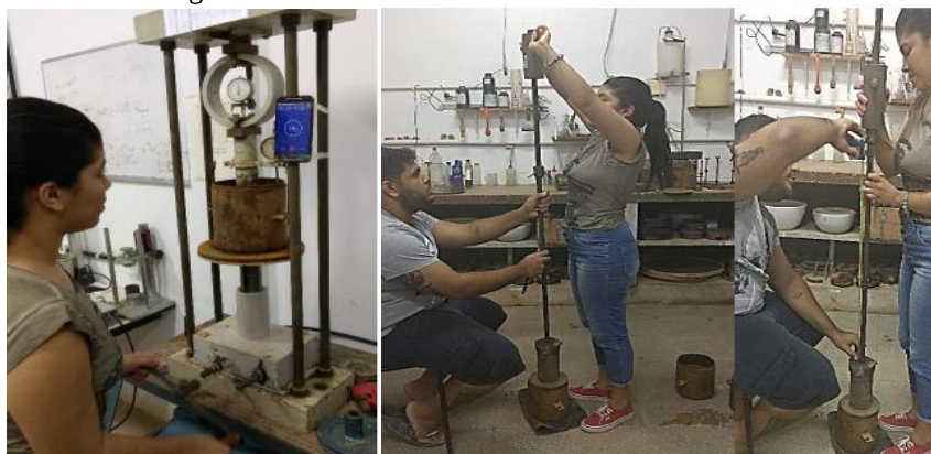
Figura 2: Ensaio CBR e Barra Mina em Laboratório.
