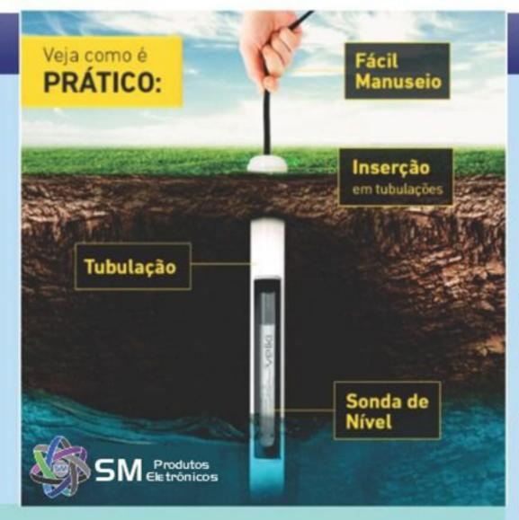
Sonda de Nível tipo piezo-resistivo, opera através de um diafragma, em contato direto com o fluído. Com sensor interno, convertendo a variação de pressão em variação proporcional de resistência elétrica. Transformando em sinal de corrente 4-20 mA, podendo ligar em qualquer tipo de dispositivo de automação como CLPs, indicadores digitais, etc.
