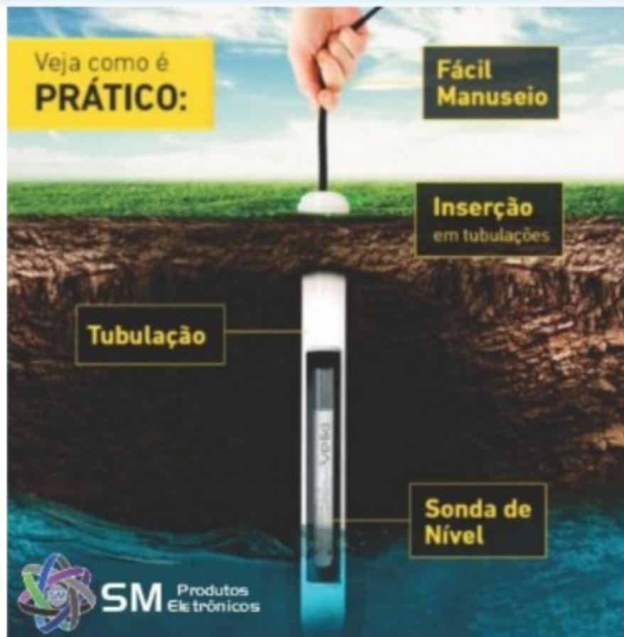
Sonda de Nível tipo piezo-resistivo, opera através de um diafragma, em contato direto com o fluido. Com sensor interno, convertendo a variação de pressão em variação proporcional de resistência elétrica. Transformando em sinal de corrente 4-20 mA, podendo ligar em qualquer tipo de dispositivo de automação como CLPs, indicadores digitais, etc.
