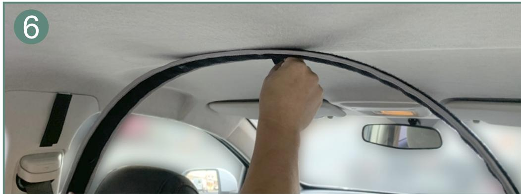
7. Ajuste a travessa do centro para a lateral do carro, flexionando-a suavemente e ajustando ao contorno do teto;
