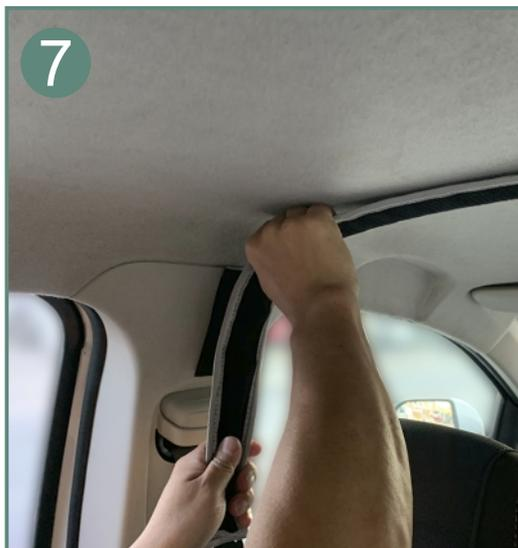
8. Fixar a extremidade da travessa aos suportes, de forma que ela fique firmemente encostada ao teto. Neste ponto você pode entortar levemente a peça, para que ela se ajuste à curvatura do teto. Repetir o procedimento para o outro lado;
