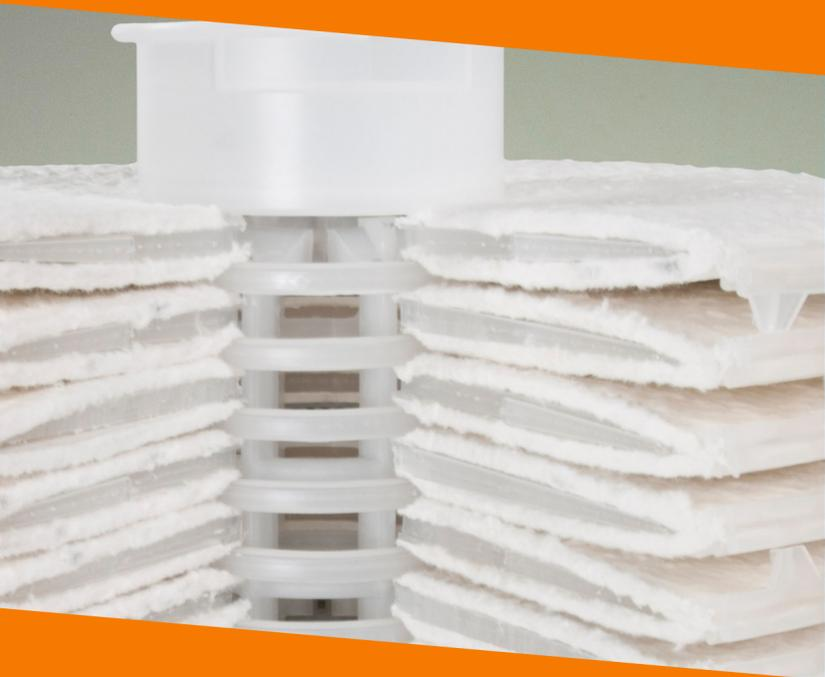
Formuladas com celulose e resina, as placas do tipo Micro-Media® Series Depth Filter Media retêm partículas finas, coloidais e até bactérias, e podem ser impregnadas com terra diatomácea ou perlita em aplicações específicas.
