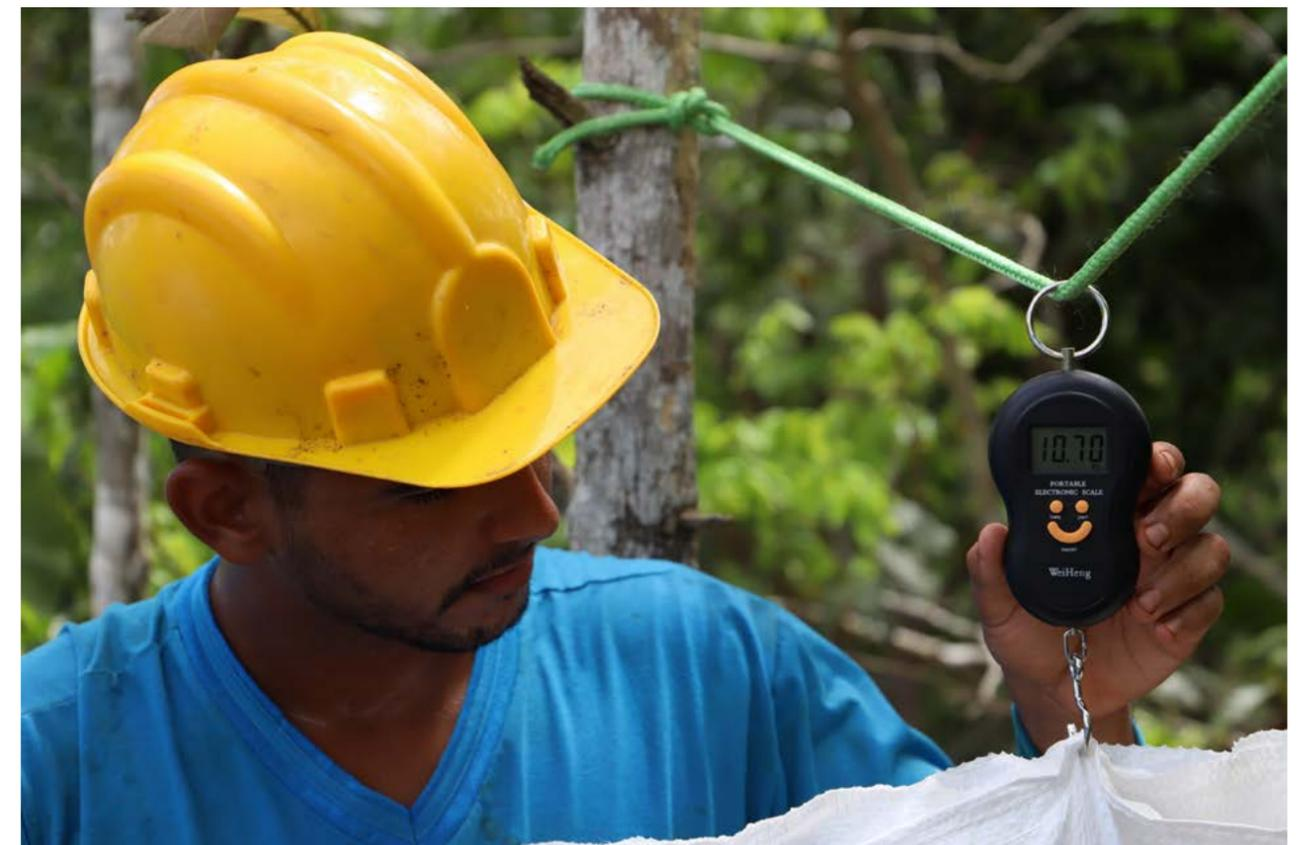
Figura 5 - Pesagem dos compartimentos da biomassa vegetal em balança digital em campo.
