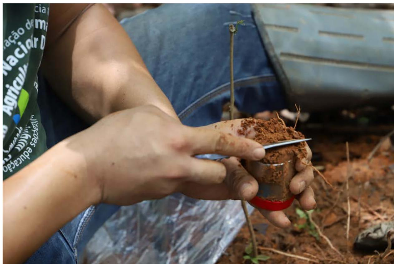
Figura 6 - Coleta de solos em anéis volumétricos das partes superficiais do solo (até 40 cm).
