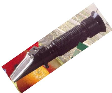
Típico refratômetro para medição do BRIX usado para frutas em geral e cana.
