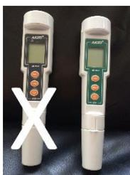
Medidores digitais de pH não são mais a melhor opção pela questão de calibrações frequentes necessárias e fragilidades. Medidor de CE – Condutividade Elétrica sim são bons e de fácil manutenção.
