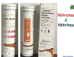
Kit de fita colorimétrica para Nitrato & Nitrito de simples uso apenas mergulhando os reagentes da fita na solução nutritiva por apenas 5 segundos e esperar 90 segundos. Depois é só comparar a cor na escala da embalagem.
