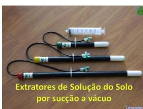
Tubos de sucção à vácuo da solução do solo.
