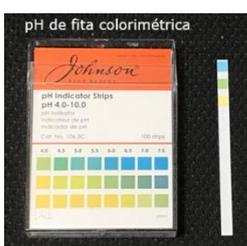
Kit rápido de pH de fita colorimétrica de confiável leitura em apenas 7 segundos. Molhar os reagentes da fita por 2 segundos e esperar 5 segundos para comparar as cores da fita contra a escala na embalagem.
