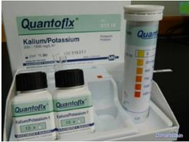
Kit de fita colorimétrica para Potássio em que se mergulha em um tubo de ensaio a fita por 2 segundos e depois em outro tubo de ensaio deixa por 1 minuto a fita mergulhada com 10 gotas do reagente que vem nas garrafinhas. Pronto, pode comparar a cor na escala da embalagem.
