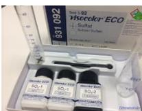
Kit de turbidez para Sulfato. Na proveta da direita preencher a amostra com 20 ml e adicionar 10 gotas do reagente N°1 e uma colherinha do reagente N°2 que é um sal solúvel. Se tiver Sulfato na amostra, esta ficará turva. Daí se despeja aos poucos essa solução no outro tubo que tem um "X" no fundo. Quando olhando por cima desse tubo não mais se conseguir visualizar o "X" no fundo da proveta, identificaremos na escala dessa proveta o teor de Sulfato em ppm.
