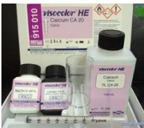
Kit de titulação para Cálcio. Coloca-se uma amostra de 5ml na proveta e 2 gotas de cada reagente. A solução ficará vermelha e do terceiro reagente da garrafa maior se enche a seringa e vai gotejando na proveta até a solução mudar de cor para azul. Daí se observa na escala da seringa que para 1 mmol = 40ppm de Cálcio.
