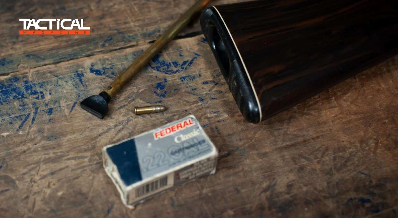
Baseado nesse material, a Remington projetou um rifle semiautomático em calibre .22LR, com um carregador tubular metálico para 14 cartuchos, que era inserido pela soleira da arma. Para facilitar o muniamento, os cartuchos eram inseridos soltos pelo orifício da soleira e o carregador era colocado posteriormente e girado um quarto de volta para travar.
