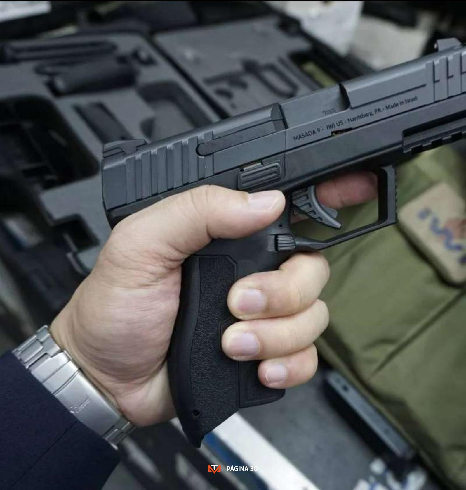
À frente do guarda-mato está o trilho de acessórios. Neste caso, é um caso MIL-STD 1913 de quatro slots, de comprimento suficiente para receber o conjunto normal de luzes montadas em armas de tamanho normal, como o X300U da SureFire ou as inúmeras variantes do TLR-1 da Streamlight.
