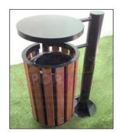
Cesto fabricado a base de Metal y Madera para Interperie (puede utilizarse Plastico reciclado) Estructura de 1" y 1 1/2" con recubrimiento de lámina rolada Calibre 16 y 20. Refuerzos en Lámina Negra cal. 10 Puerta Cerradura para mantenimiento El poste es de 2.5" ced. 30 Lleva una tapa superior para evitar que le entre agua de lluvia. Brida Reforzada interior para Taquetearse al Piso. (es posible agregar anclas para colar) Medidas: Diámetro de 3600mm x 900mm de altura A elegir
