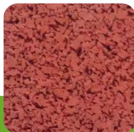
Base prefabricada de 14 mm con cubierta de hule EPDM prefabricada.
