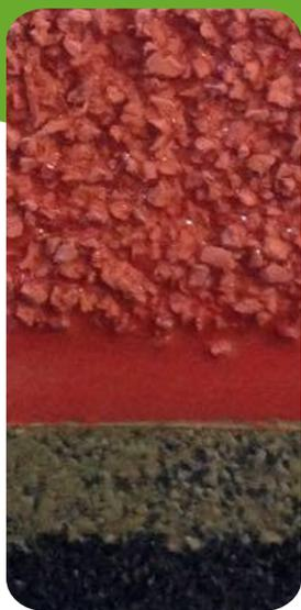
Base prefabricada de 14 mm con recubrimiento de poliuretano autonivelante y granulos de hule EPDM, CERTIFICADO POR LA IAAF
