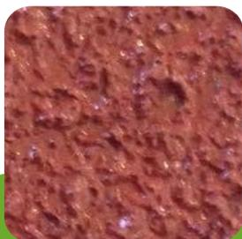
Base prefabricada de 14 mm espreada a base de poliuretano y gránulos de hule EPDM CERTIFICADO POR LA IAAF
