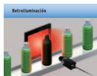
Inspecciones de la forma exterior
