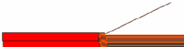
Se abre el siguiente hilo del cable y se procede a enrollar ambos cables Paso 3
