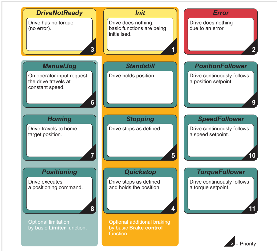
[9-1] Estados de función de la máquina de estado "Funciones básicas"
