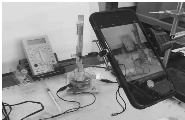
Montaje para microtitulometría con captura de video
