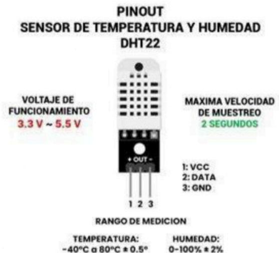
Ilustración 1 PINOUT de un sensor de temperatura y humedad DHT22
