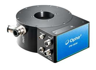
"IPM-10" Medición de potencia láser en entorno industrial
