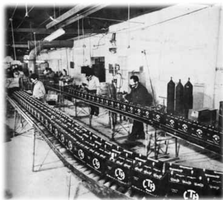
Línea de producción de ambas marcas de acumuladores
