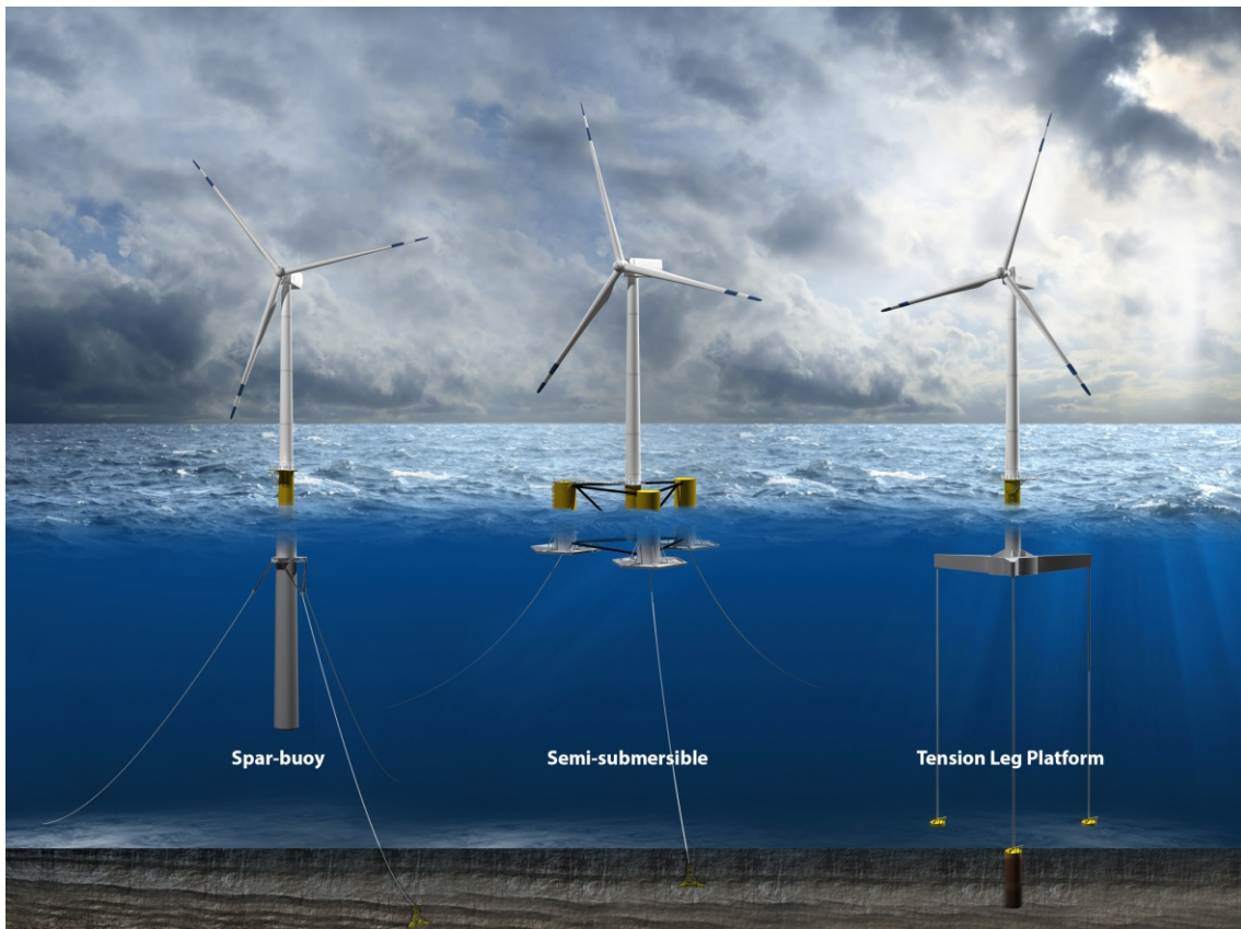
Figura 50. Tecnologías de cimentación profunda. [4]
