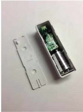
Instalación de la batería
