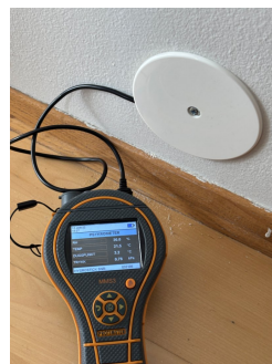
Måling av relativ luftfuktighet i lukket veggkonstruksjon mellom stue og dusjsone.
