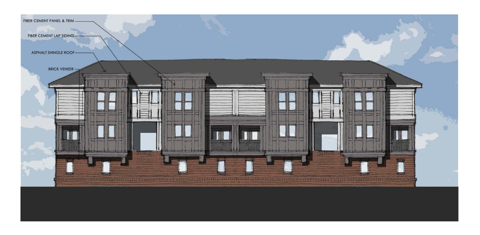
TYPICAL CARRIAGE BUILDING BACK ELEVATION
