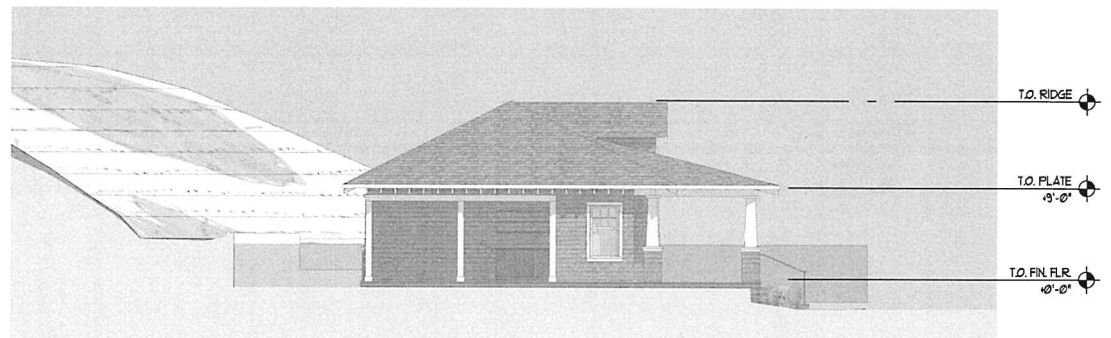
4 A.D.U. ELEVATIONS - WEST A3.2 1/8" = 1'-0"
