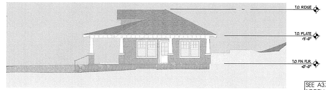
2 A.D.U. ELEVATIONS - EAST A3.2 1/8" = 1'-0"
