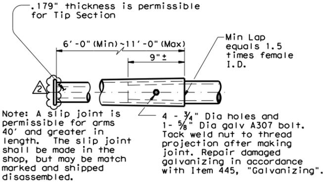
**SLIP JOINT DETAIL (CLAMP-ON ARM)**
