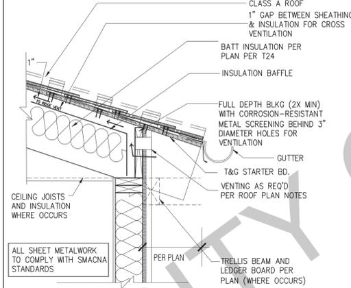
6 IGNITION RESISTIVE RAFTER EAVE HEAVY TIMBER SCALE: 1"=1'-0"
