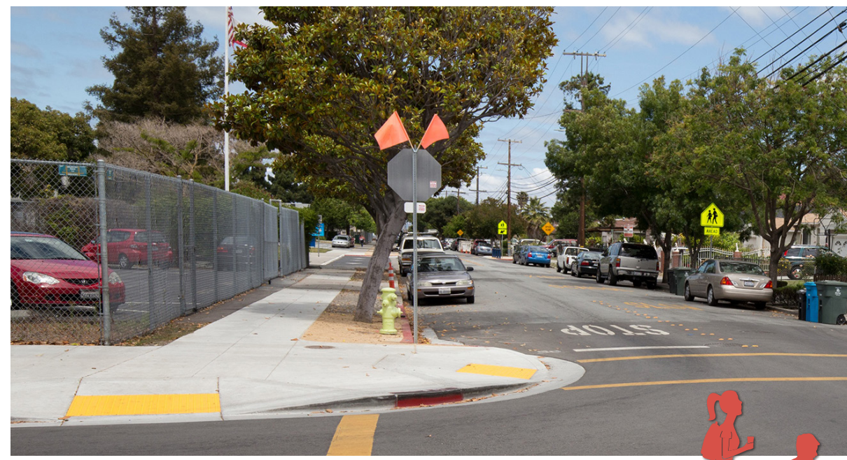
Curb Extension / Extensiones de la Banqueta
