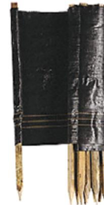
**Propósito:** Las barreras contra sedimentos, tales como las mallas de retención, se pueden utilizar para disminuir la velocidad de la escorrentía. Las barreras se utilizan para filtrar los sedimentos de la escorrentía.
