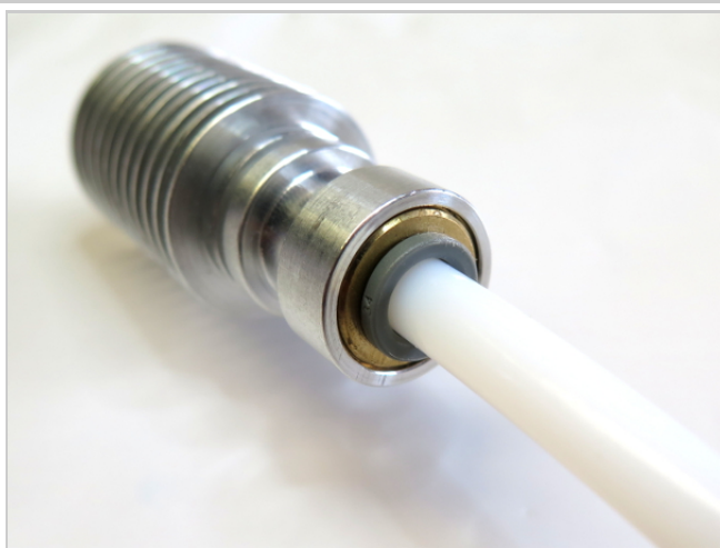
3mm PTFE Tubing Inserted.
