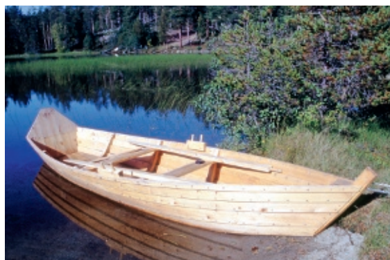
Fig. 0.6. Åfløyene i Rauma er litt annleis enn dei i Gudbrandsdalen. Denne er bygd av Arne Anset, Lesjaverk, Lesja kommune. Ho er bygd av furu med greinkrok i banda og ein bordgang meir enn åfløya frå Fåberg. Lett kjenneleg er også gavlen. Fotograf er Åsmund Kristiansen.
