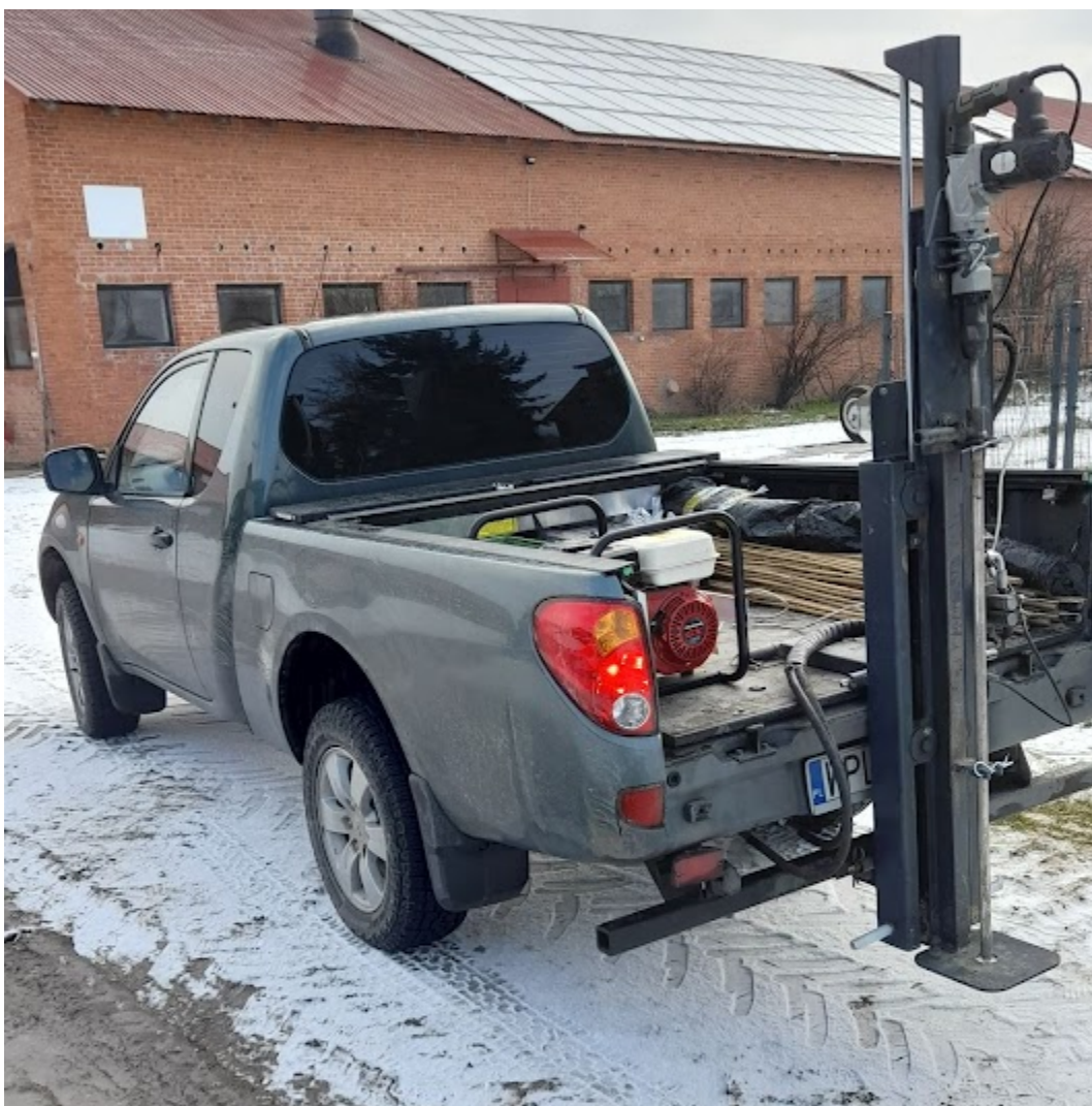
Rys. 1.5.2. Zautomatyzowany zestaw do pobierania próbek glebowych zamontowany na pojeździe terenowym firmy AgVisor.
