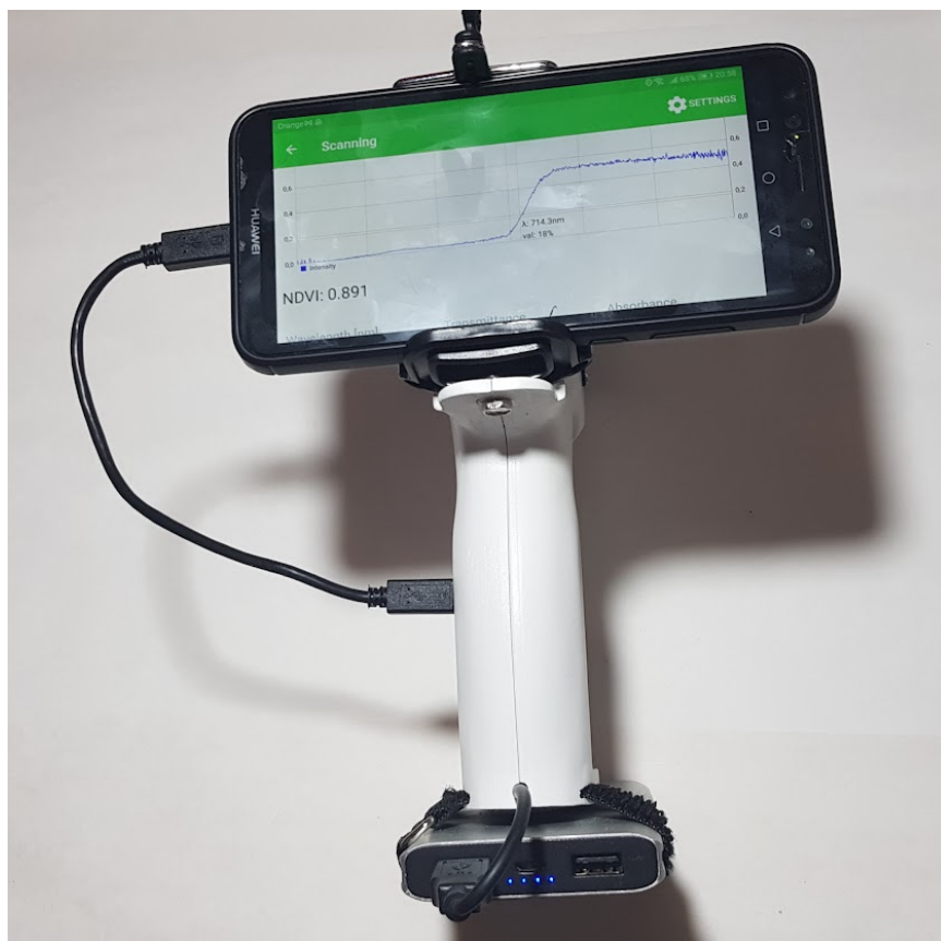
Rys. 1.3.2. Aplikacja mobilna wyświetlająca dane spektralne z prototypu ScanSpectrum.
