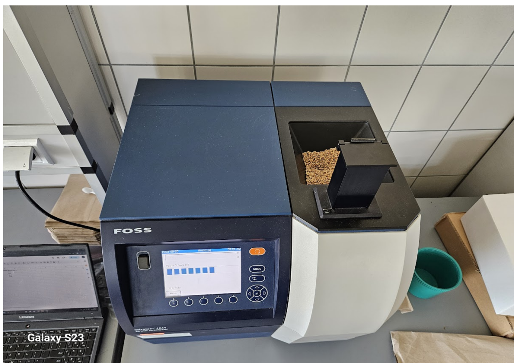
Rys. 3.1.3. Analiza jakościowa ziaren przy pomocy urządzenia foss infratec w laboratorium SGGW.
