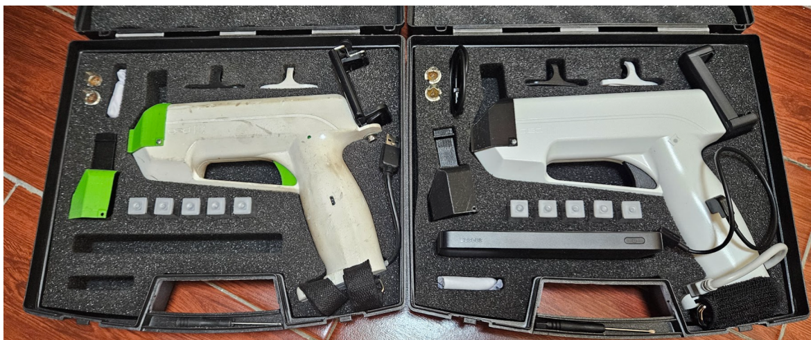
Rys. 3.3.1. Po lewej wersja spektrometru przed usprawnieniami na podstawie opinii rolników, po prawej wersja usprawniona.
