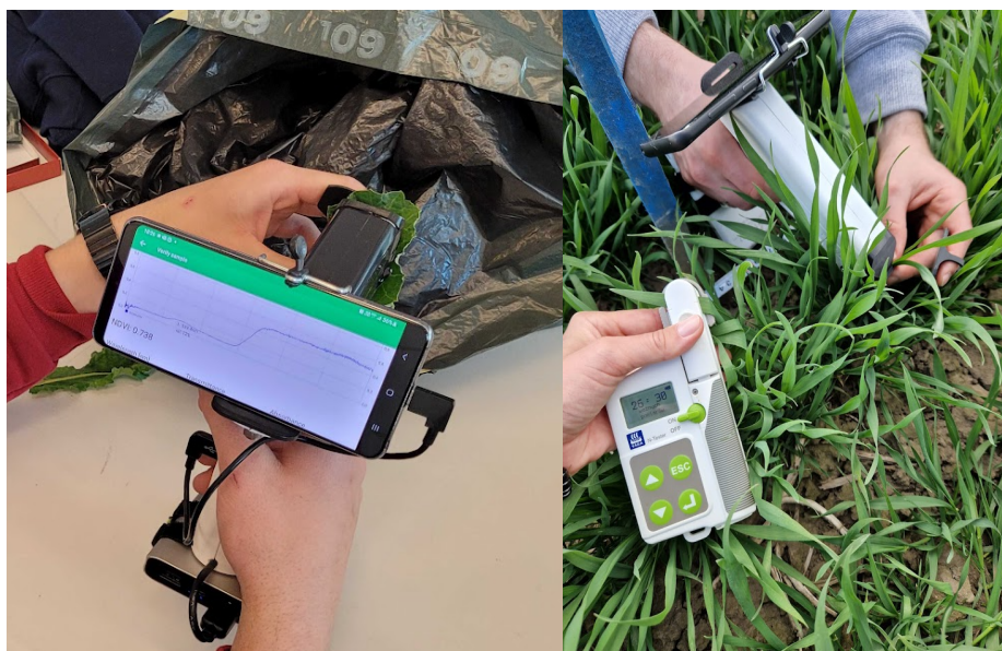
Rys. 1.7.3. Wykonywanie pomiarów za pomocą prototypów ScanSpectrum i urządzeń referencyjnych.
