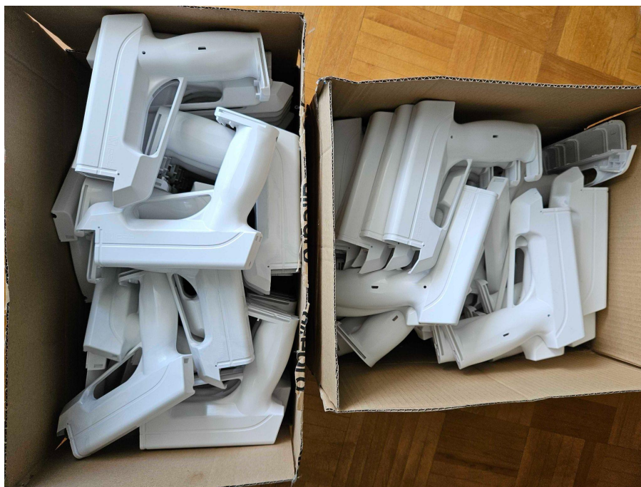
Rys. 3.4.2. Obudowy urządzenia ScanSpectrum wykonane metodą wtrysku na potrzeby serii pilotażowej.
