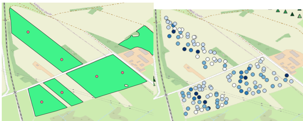
Rys. 2.4.2. Porównanie ilości punktów zebranych do analizy chemicznej z ilością punktów pomiarowych możliwych do osiągnięcia analizą optyczną.
