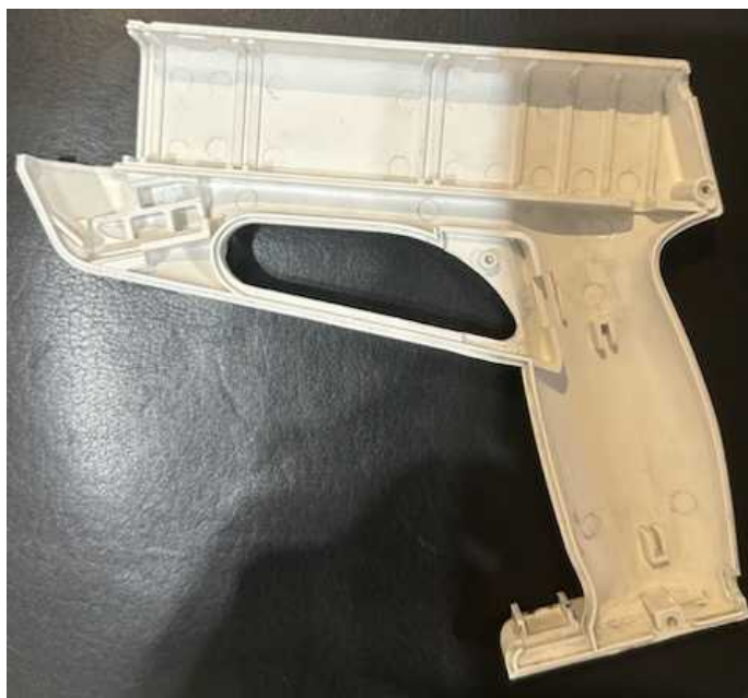
Rys. 1.1.3. Pierwsze elementy obudowy wykonane metodą wtrysku.
