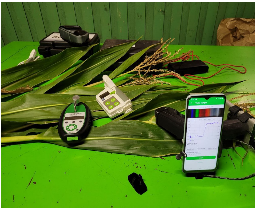
Rys. 2.1.5. Pomiary spektralne liści kukurydzy za pomocą ScanSpectrum i urządzeń referencyjnych.
