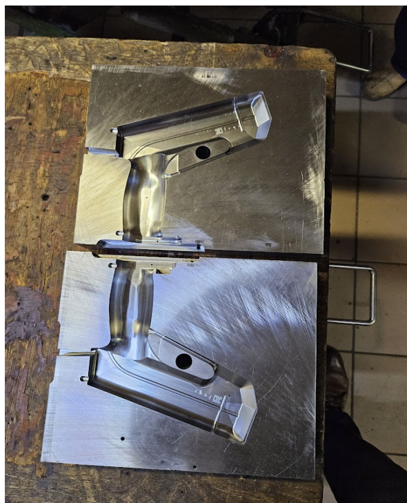
Rys. 1.1.2. Forma wtryskowa wykonana przez firmę Plastvision.
