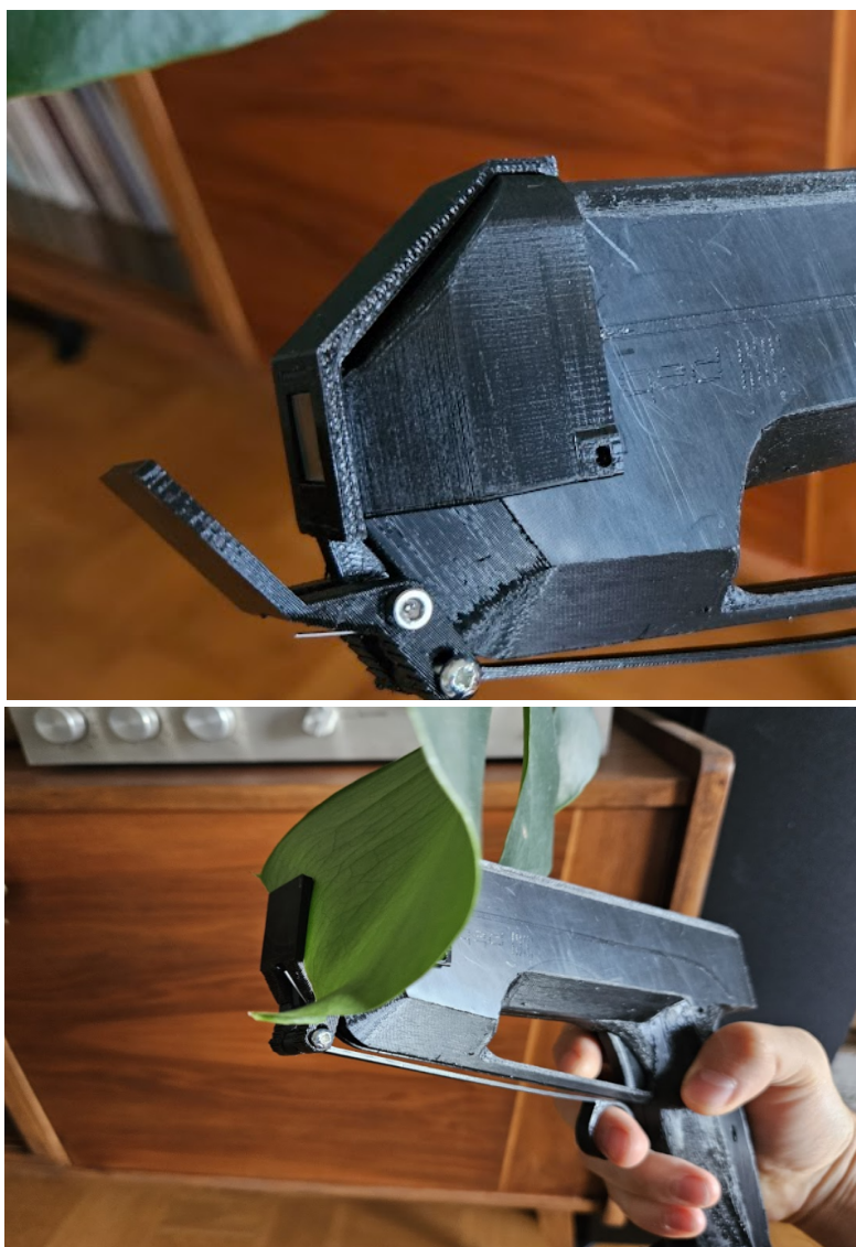
Rys. 4.2.4. Rozszerzenie zestawu pomiarowego o możliwość wykonywania pomiarów liści jedną ręką.
