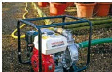
WH-serien har pumpetrykk opp til 5 bar, som gjør den velegnet til f.eks. brannslukking
