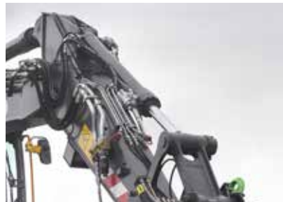
Tvådelad bom eller tvådelad avvinklingsbar bom Lasthållningsventiler på skopocylindrarna, båda sidor (EWR170E)
