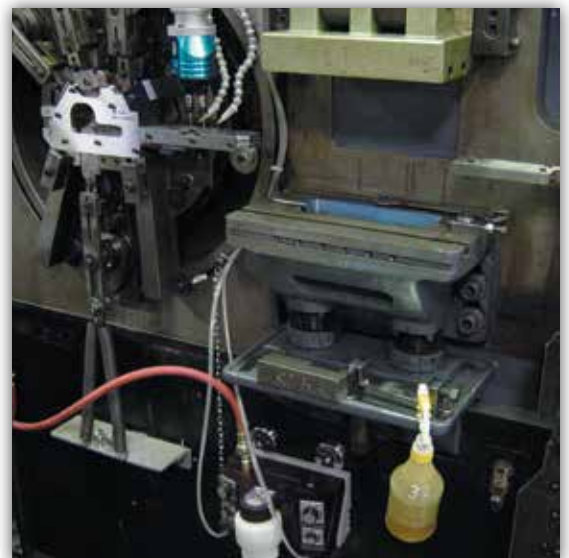
Lubricación de cantidad mínima usada en un centro de roscado
