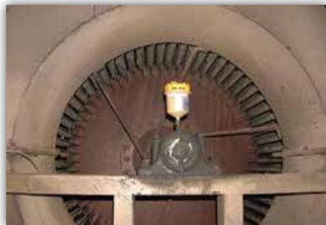
La graser Streamliner® V instalada en un soplador
