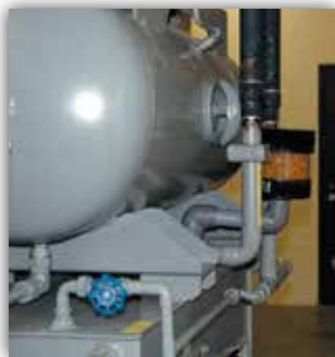
Respirador Watchdog® instalado en un tanque hidráulico.
