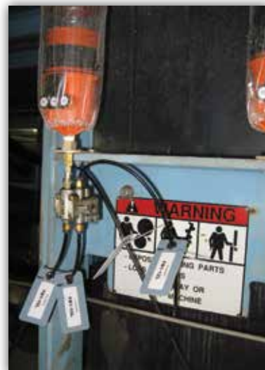
Streamliner M® con un bloque de distribución de 4 puntos
