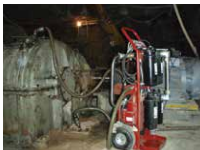
Sistema de Filtración con Carrito de Filtro Portátil
