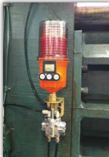
Streamliner M® con un bloque de distribución de 4 puntos
