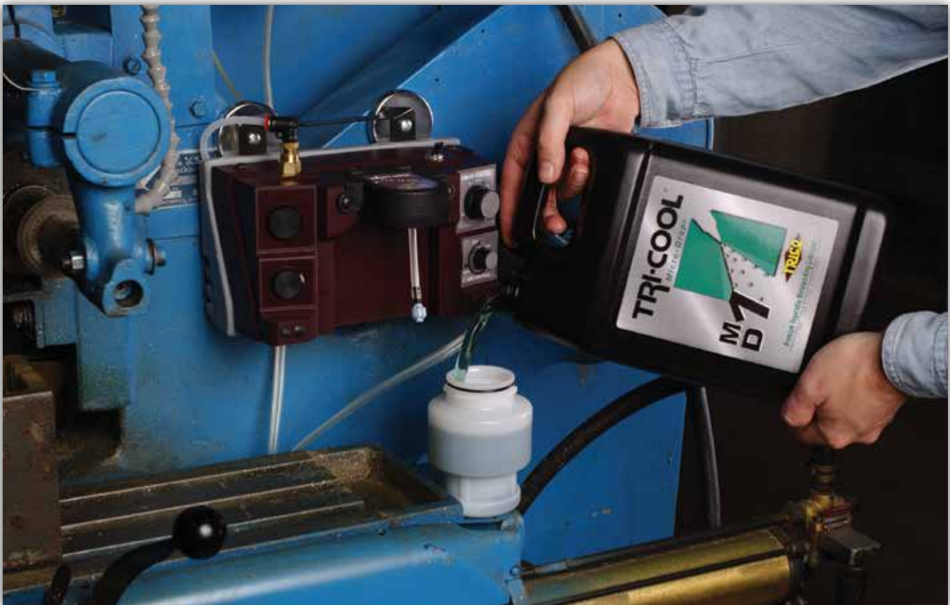
El micro-dispensador siendo llenado con lubricante Tri-Cool MD-1
