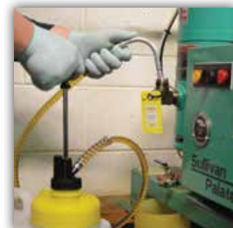
Un contenedor para aceite de Oil Safe® siendo llenado con una Bomba para Barriles EZI-ACTION
