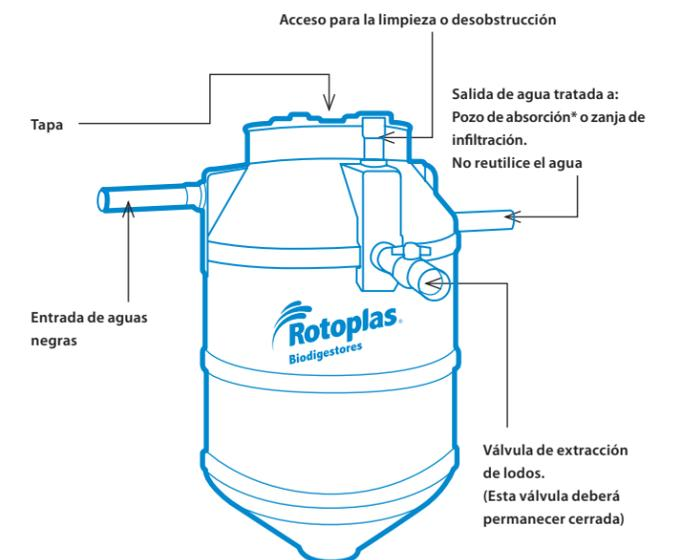
Fig. 29. Componentes del Biodigestor.
