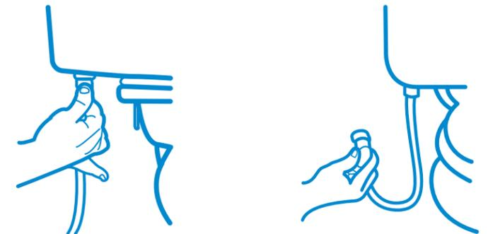
Fig. 24. Conexión de manguera flexible.
