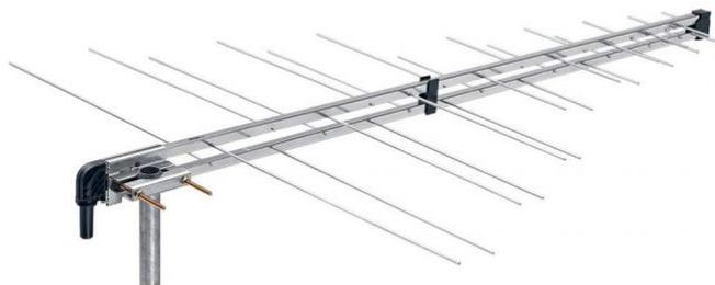
Antenna Log periodica premontata caratterizzata dall'estrema facilità di installazione grazie al **connettore** posto in prossimità dell'attacco al palo. Grazie allo speciale attacco a palo è possibile installare l'antenna sia in **polarizzazione** verticale sia in orizzontale **senza adattatori** o altri accessori. Distribuzione **geometrica** dei dipoli **riprogettata** per filtrare i segnali LTE superiori a 790MHz. Antenna di colore bianco.
