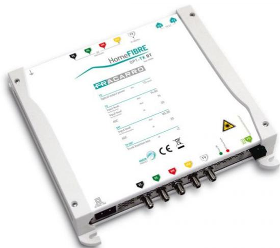
Trasmettitore ottico per la distribuzione fino a 4 satelliti su una singola fibra con tecnologia CWDM (Coarse Wavelength Division Multiplexing). Soluzione innovativa che permette di trasmettere l'intera banda TV, comprensiva dei segnali radio, e una intera posizione orbitale su una singola fibra. 7dBm con laser FP SAT+TV+FM, lunghezza d'onda 1310nm. (dimensioni 230x230x50mm)
