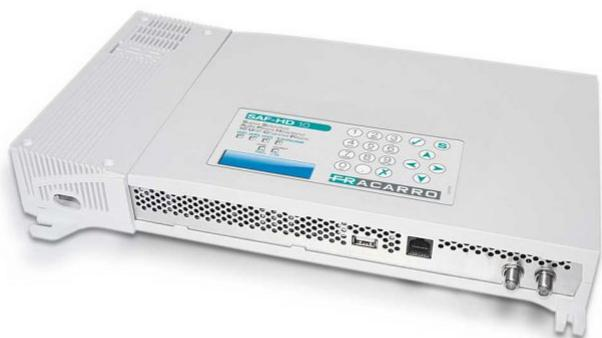
Nuova centrale SMATV compatta per il filtraggio di segnali DVB-T e DVB-T2 (alta definizione). La centrale è dotata di filtri agili per la banda UHF con altissima selettività, grazie alla tecnologia SAW di cui sono dotati, e CAG (Controllo Automatico del Guadagno) che garantisce la costanza del livello in uscita anche in caso di variazioni del segnale d'ingresso.
