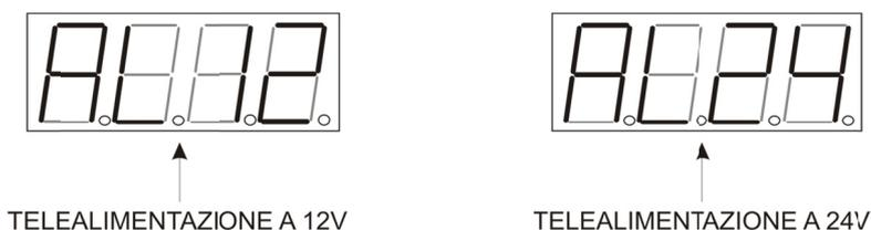
Per procedere all'impostazione della tensione fornibile di telealimentazione: premere brevemente **ENTER** e il display inizierà a lampeggiare entrando nella modalità di impostazione parametri.
