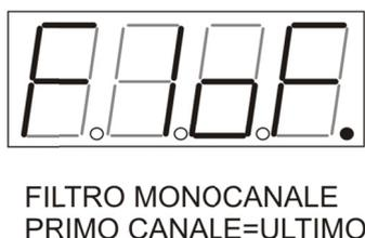
Per modificare il canale d'inizio: selezionare il display sul filtro desiderato (l'accensione del secondo led conferma che ci si trova sul primo canale del filtro), premere brevemente **ENTER** (il display inizierà a lampeggiare), premere il tasto **UP** per incrementare il N° canale o il tasto **DOWN** per diminuirlo. Premere **ENTER** per confermare.
