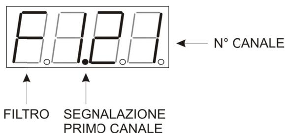
Premendo nuovamente il tasto **UP** verrà visualizzato il canale di fine filtro **F1**, condizione segnalata dall'accensione del quarto led puntiforme.
