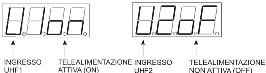
Per uscire dal menu di impostazione telealimentazione: premere contemporaneamente **UP** e **DOWN** e il display tornerà nella condizione di POWER ON.
