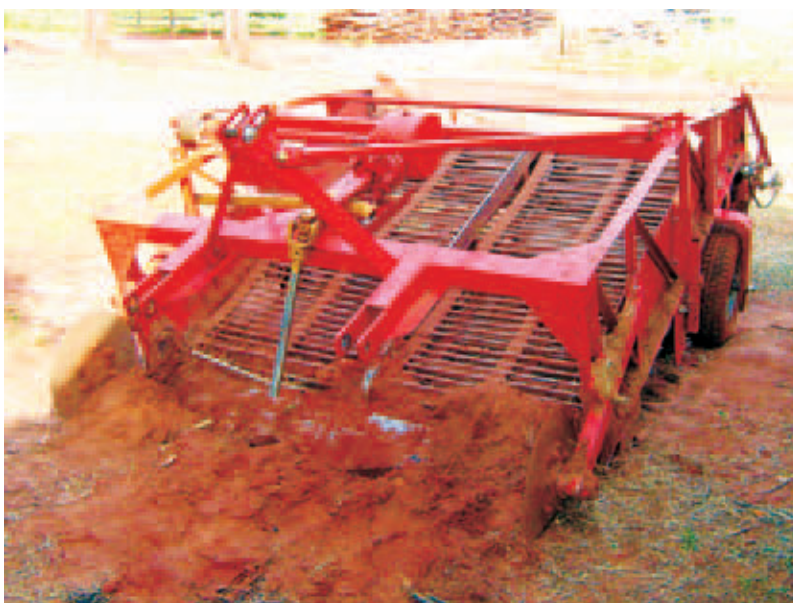
Figura 66 – Colhedeira com esteira elevatória. Foto: José Osmar Lorenzi
