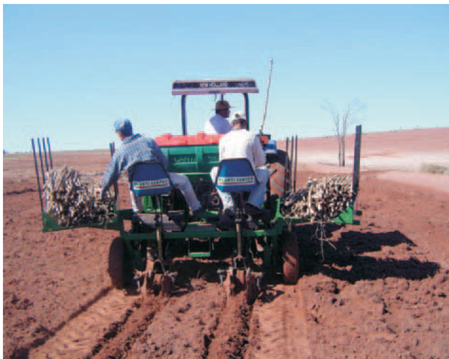
Figura 25 – Plantadeira de duas linhas que usa ramas inteiras.
