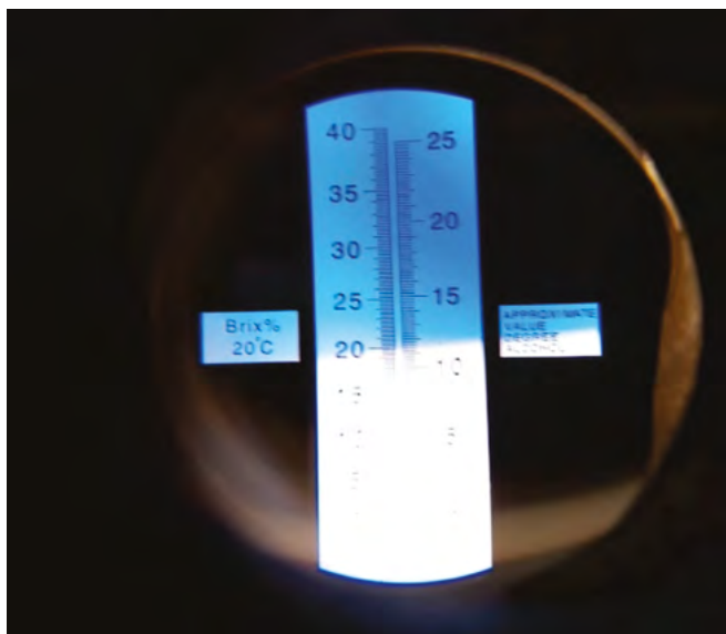
Figura 6 – Exemplo de refratômetro na medição de Brix para colheita de café cereja para processo de fermentação induzida.
