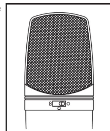
peut être sélectionnée à l'aide du commutateur à glissière à trois positions situé à l'arrière du microphone. Chaque courbe présente des caractéristiques de captation distinctes en ce qui concerne la sensibilité et la réponse en fréquence aux sons provenant de différentes directions. La section suivante traite de certaines particularités de chaque courbe, pour vous aider à choisir le meilleur paramétrage pour votre application.
