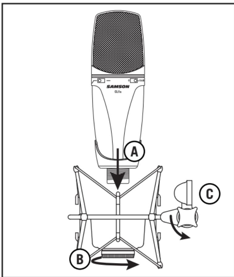
Per un ulteriore isolamento, il CL8a può essere montato sul supporto antiurto a ragno opzionale SPO1 per isolare il microfono dalle vibrazioni e dai rumori meccanici trasmessi attraverso l'asta microfonica. Per montare il CL8a sull'SPO1, procedere come segue.
