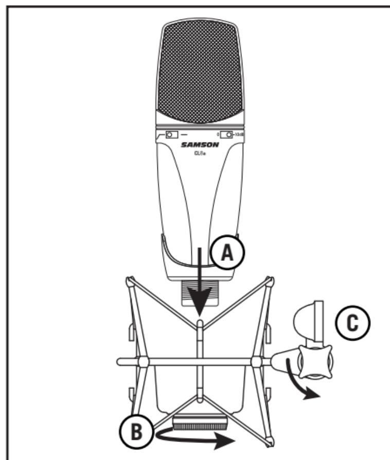
Para obtener un aislamiento adicional, el modelo CL8a se puede instalar en el soporte araña SP01 opcional para aislar el micrófono de las vibraciones y los ruidos mecánicos transmitidos a través del soporte (pie) del micrófono. Siga los pasos a continuación para instalar el micrófono CL8a en el soporte araña SP01.
