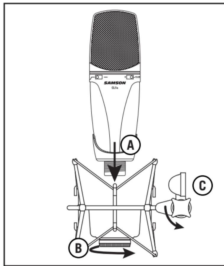
Pour une isolation supplémentaire, le CL8a peut être monté sur le support antichoc araignée SP01 en option, afin d'isoler le microphone des vibrations et des bruits mécaniques transmis par le pied de micro. Suivez les étapes ci-dessous pour monter le CL8a sur le SP01.
