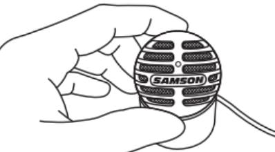
Positionieren Sie das Mikrofon so, dass es frontal zur Schallquelle gerichtet ist,
