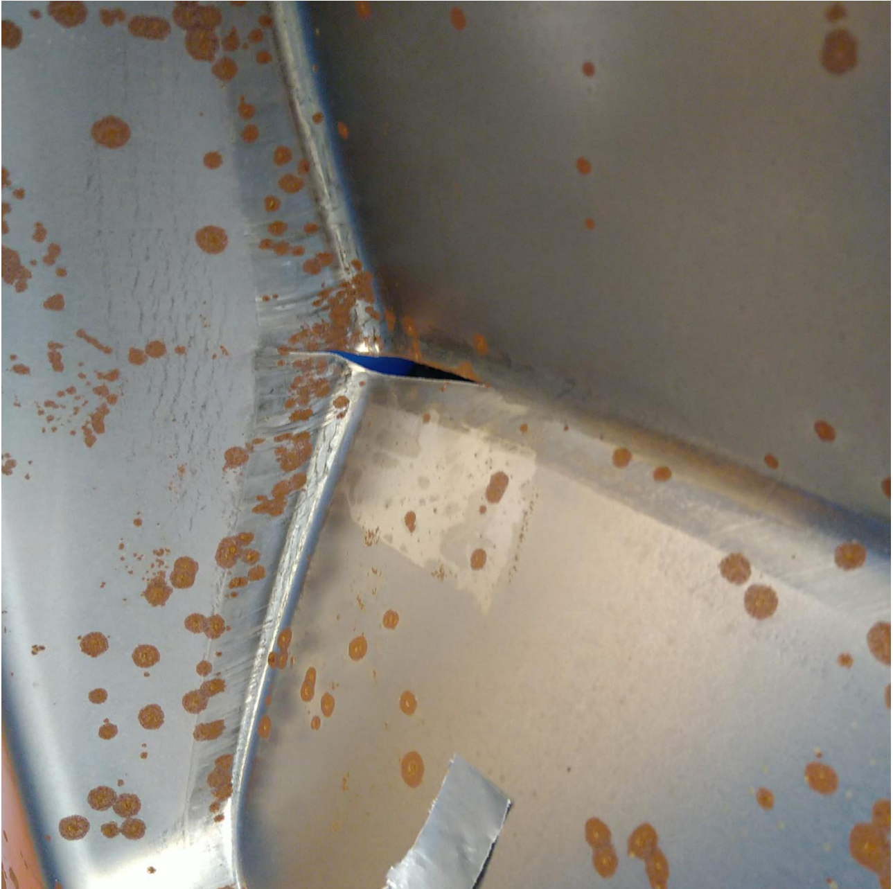
Kuva 2. Repeämäkohta syvävedetyssä kappaleessa.
