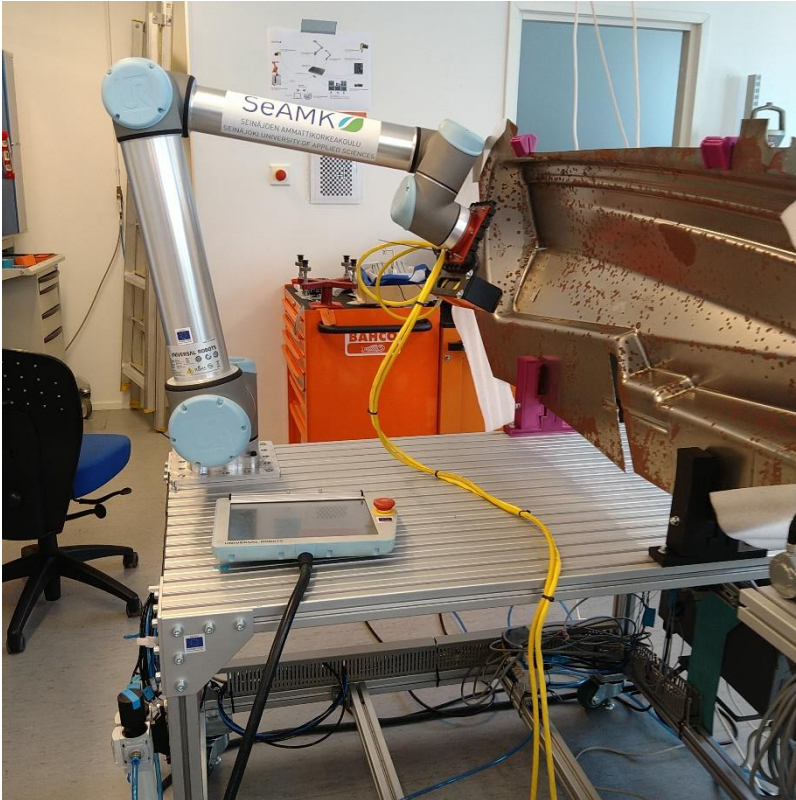
Kuva 7. 3D-tulostetut puristimet pitävät pellin pystyasennossa.
