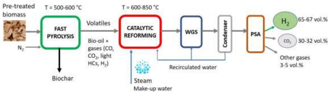
Kuva 6. Vedyn tuotanto biomassasta pyrolyysillä + in-line-höyryreformoinnilla
