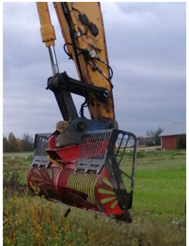
Kuva 8. Kosteikon niittokauhaperkaus poistaa kasvimassaa tehokkaasti. Niittokauhaperkauksessa voidaan säilyttää kasvin juuristot. Tämä vähentää ojaston tai kosteikon eroosiota ja ravinnehuuhtoumia. Osmankäämiä voidaan käyttää myös ojastoissa suodattimena, joka kerää kuivatusveden ravinteita (Kuva: Jari Luokkakallio).
