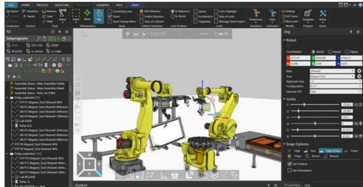
Kuva 3. Testiympäristö ja siitä tehty simulointi- ja etäohjelmointimalli Visual Components -ohjelmistossa.
