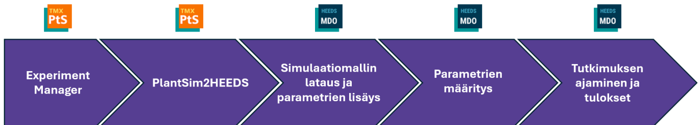
Kuva 1. Plant Simulation- ja HEEDS-ohjelmien välinen työnkierto.
